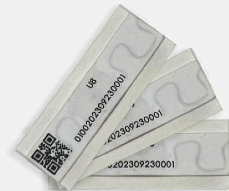
LT015 è un'etichetta RFID in **tessuto**, morbida e flessibile. Rettangolare, si applica facilmente ai capi **tramite termosigillatrice** a 200°C, con una pressione di 2 Kg/cm<sup>2</sup> per 30 secondi.
