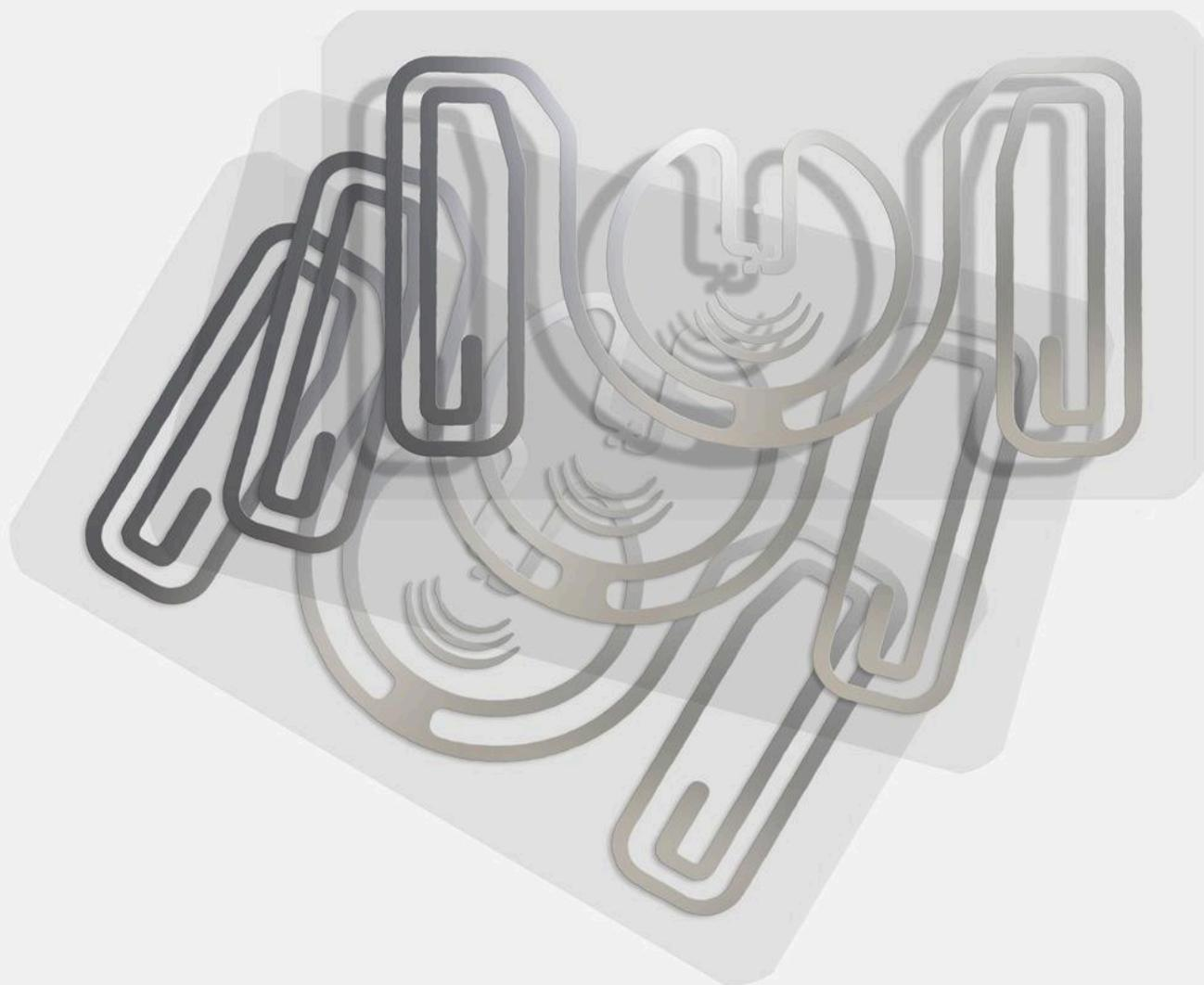
WT002 è un *wet inlay* in PET, caratterizzato da flessibilità, resistenza al taglio e alle alterazioni atmosferiche. Rettangolare, **misura 36 x 22 x 0,23 mm** ed è applicabile ai materiali non metallici, attraverso l'apposito adesivo. Ha una superficie trasparente ed è disponibile nella **frequenza UHF**, con il chip **MONZA R5**.
