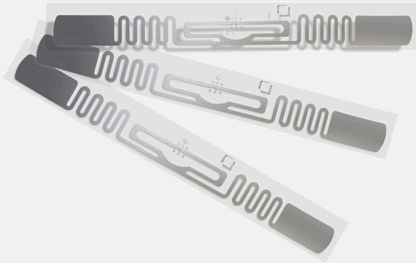
WT003 è un *wet inlay* in PET, materia caratterizzata da flessibilità, resistenza al taglio e agli shock termici. Dall'aspetto rettangolare, è adesiva e flessibile, e **misura 64 x 6 mm**.
