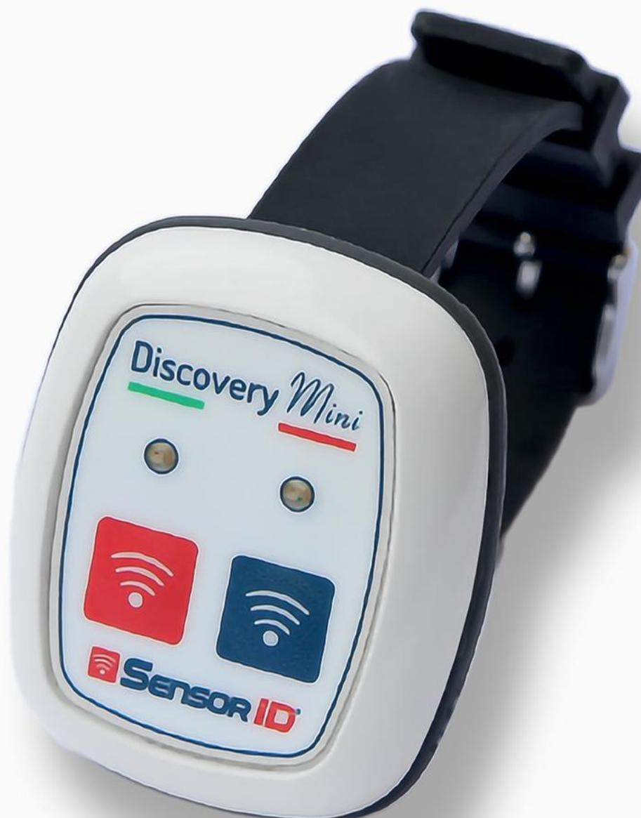
Discovery Mini è il wearable **piccolo, ultraleggero ed ergonomico che legge i tag RFID** e migliora l'efficienza delle operazioni di picking grazie a: un'**elevata sensibilità dell'antenna RFID**, che consente la lettura e la scrittura di tag UHF passivi fino alla distanza di 1 m. Inoltre, è integrabile con smart glass.
