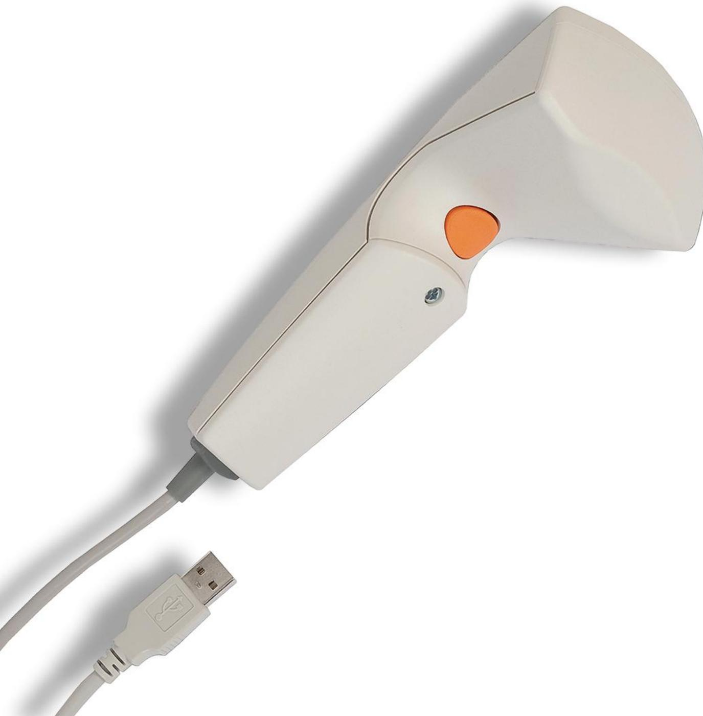
Discovery KE è un lettore **UHF a bassa potenza con emulazione di tastiera**, progettato per rilevare **tag RFID UHF fino a 50 cm**.
