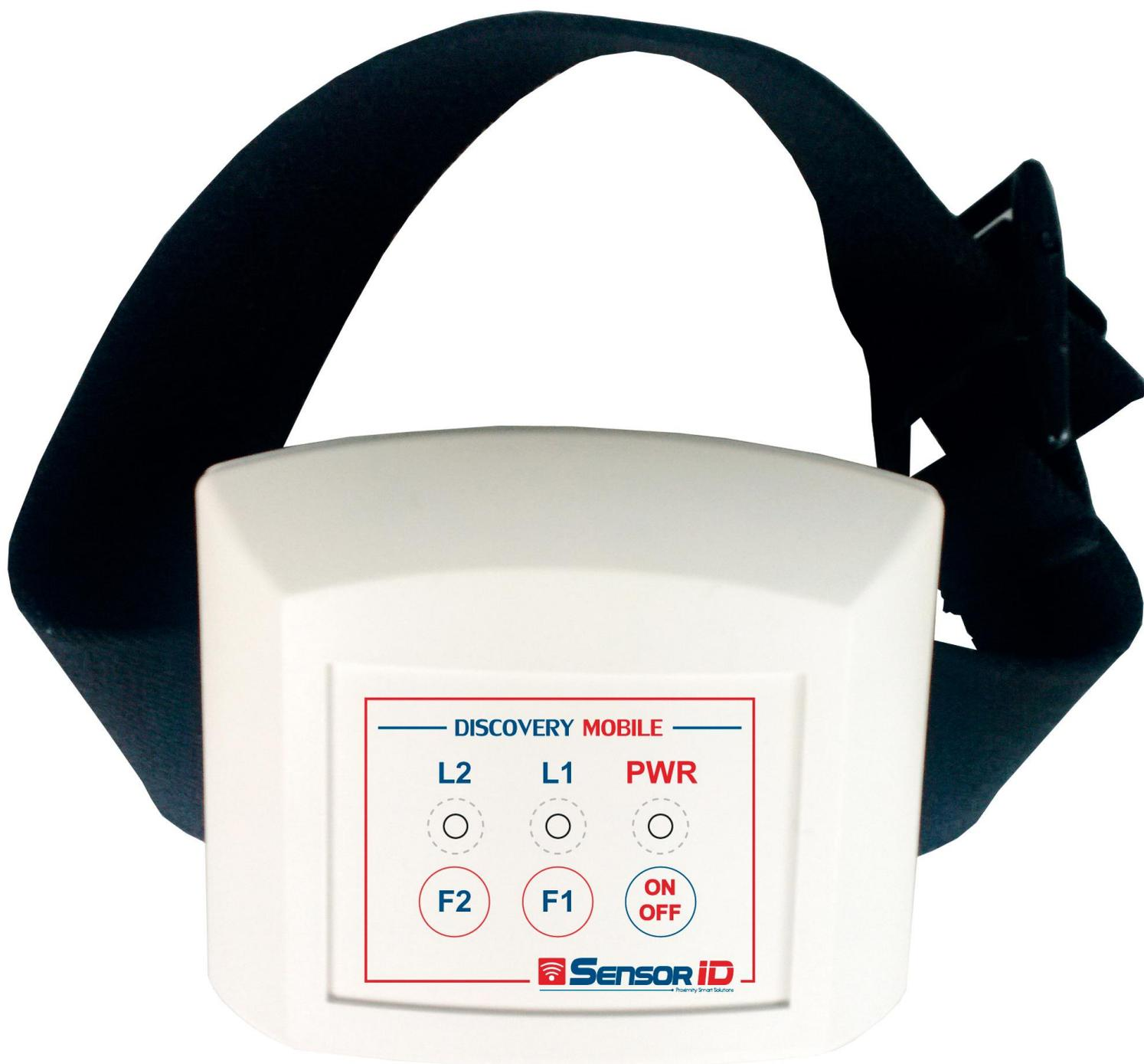
Discovery Mobile LF è il **wearable per la raccolta dei rifiuti** che legge il tag RFID, posizionato sul sacco o sul bidone, in modo da registrare la consegna dei rifiuti per ciascun utente e trasferire le informazioni sul cloud in tempo reale. **Grazie all'integrazione del modulo GPS, il sistema è in grado di registrare le**
