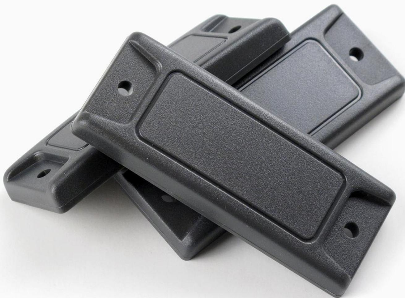
HT003 è un hard tag RFID in ABS, polimero termoplastico caratterizzato da un'elevata resistenza agli urti, agli shock e alle basse e alte temperature; infatti HT003, **durante lo stoccaggio, raggiunge la massima temperatura a 80°**. Questo hard tag RFID si applica su **superfici non metalliche** tramite avvvitamento, attraverso i due fori laterali, o tramite supporto
