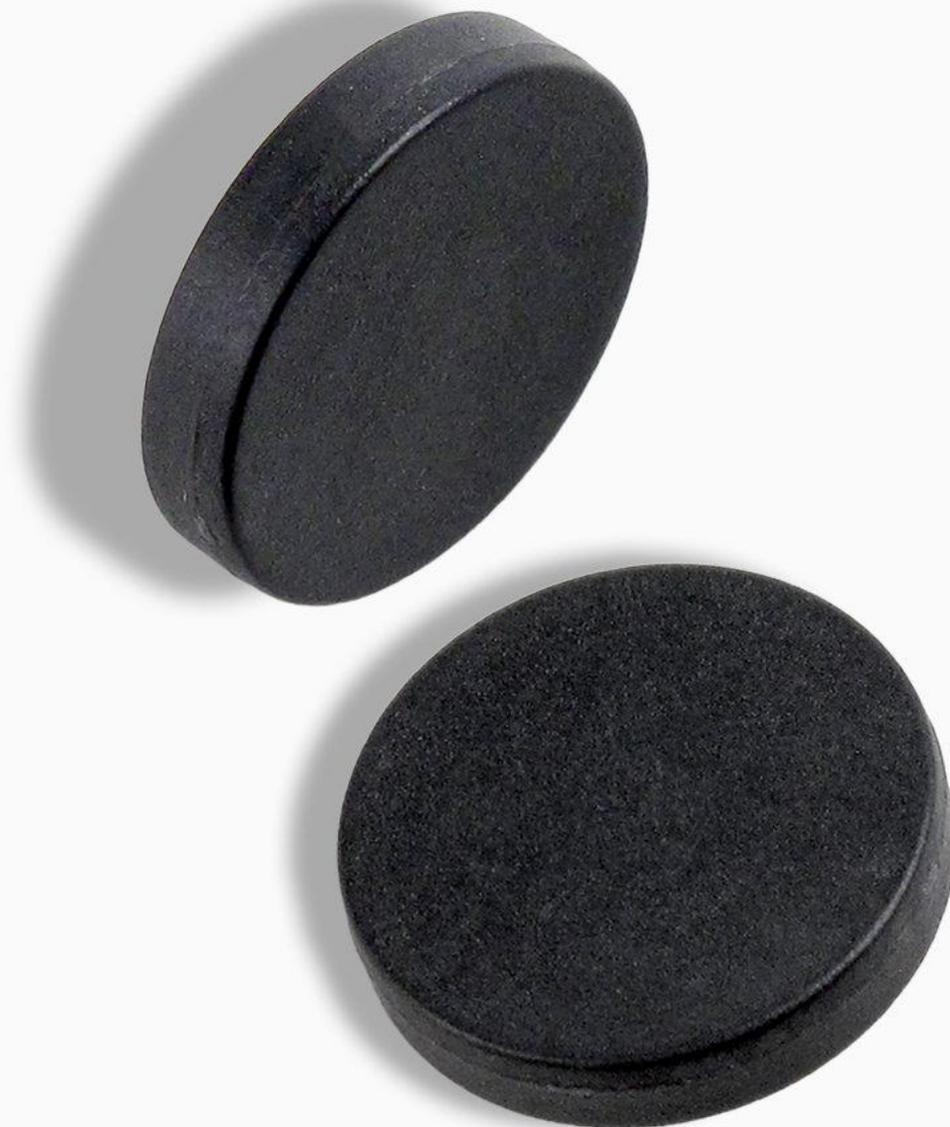
HT028 è un **"button tag"** - simile a un **bottono** - in nylon, dalle caratteristiche materiali di robustezza, resistenza agli urti, agli agenti chimici, a muffe e batteri. Di forma circolare, è **molto piccolo e sottile, oltre che leggerissimo**. È disponibile in due misure: con **diametro di 12,4 mm per 2 mm di spessore e con diametro di 14,5 mm per 3 mm di spessore**. Questo discreto tag RFID è **progettato per**
