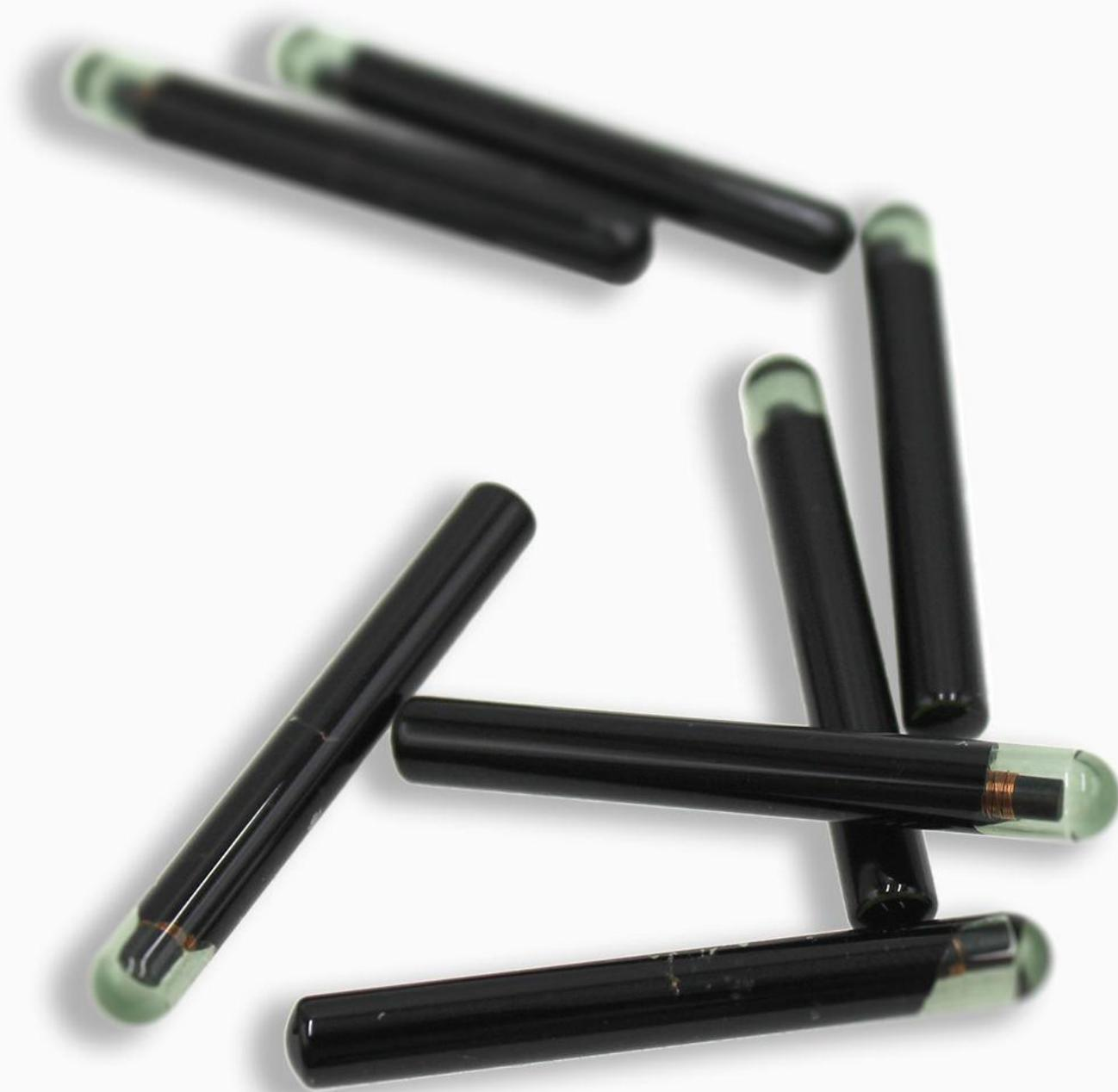
GT001 è un “**glass tag**” in vetro biocompatibile, materiale trasparente, chimicamente inalterabile e versatile. Di forma cilindrica, **ha un diametro di 3,85 x 32 mm**. Per la sua conformazione particolare, è stato progettato per adattarsi a qualsiasi applicazione RFID senza contatto, nell’ambito della **gestione degli animali domestici, da allevamento e da laboratorio**. Questo glass tag è applicabile tramite ingerimento -
