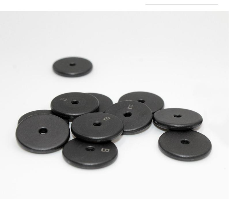
HT022 è un hard tag RFID in PA9T, una resina di nylon, cioè una speciale poliftalammide dalle eccezionali proprietà di: resistenza termica, stabilità dimensionale, fluidità e resistenza ad agenti chimici ed all'abrasione. Di forma rotonda, ha un alloggiamento sottile ma robusto. Con un diametro di 22 mm per 3 mm di spessore, con un
