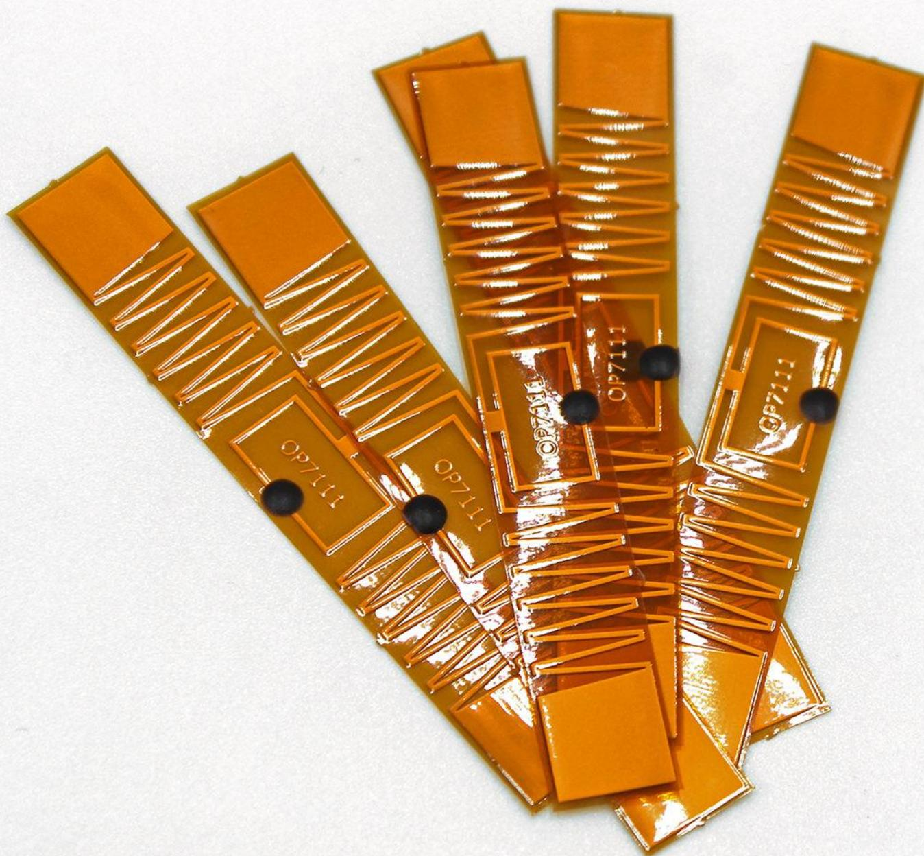
HT032 è un **"mould tag"**, uno speciale tag RFID che viene incorporato al prodotto da identificare durante la fabbricazione, tramite stampaggio a iniezione. È in **FPC (Flexible Printed Circuits)**, un circuito stampato costituito da un film in poliammide o poliestere, che **si caratterizza per l'estrema leggerezza, lo spessore sottile e la flessibilità**. Di colore
