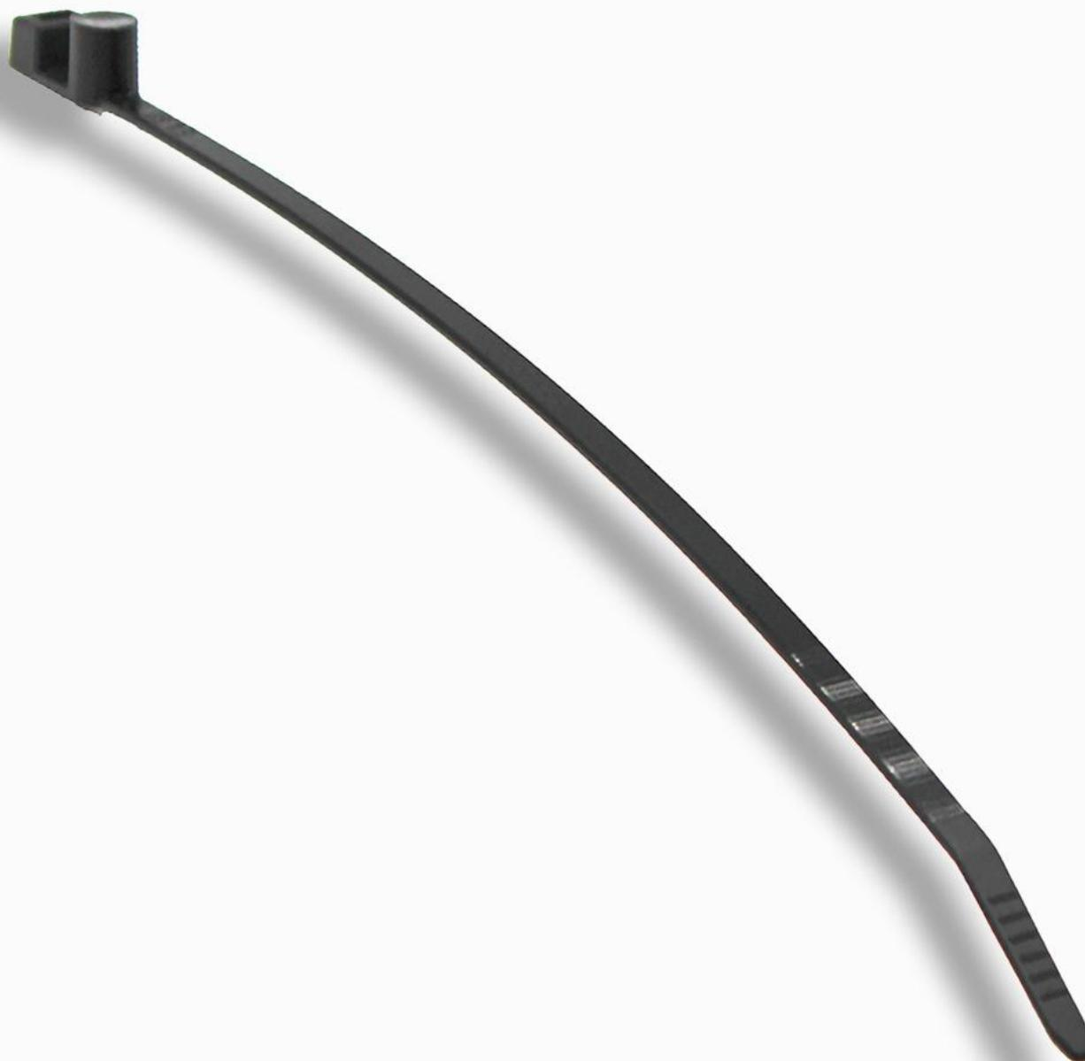
HT083 è un **"Cable tie tag"** o **"a fascetta"** in PA66, un nylon caratterizzato da durezza e rigidità, resistente all'usura, al calore e alle abrasioni. Misura 198,5 x 9 x 8 mm e pesa 2 grammi e, **grazie alla particolare forma a fascetta - cable tie -**, può essere saldamente ancorato agli oggetti da identificare. Progettato per l'applicazione su superfici non
