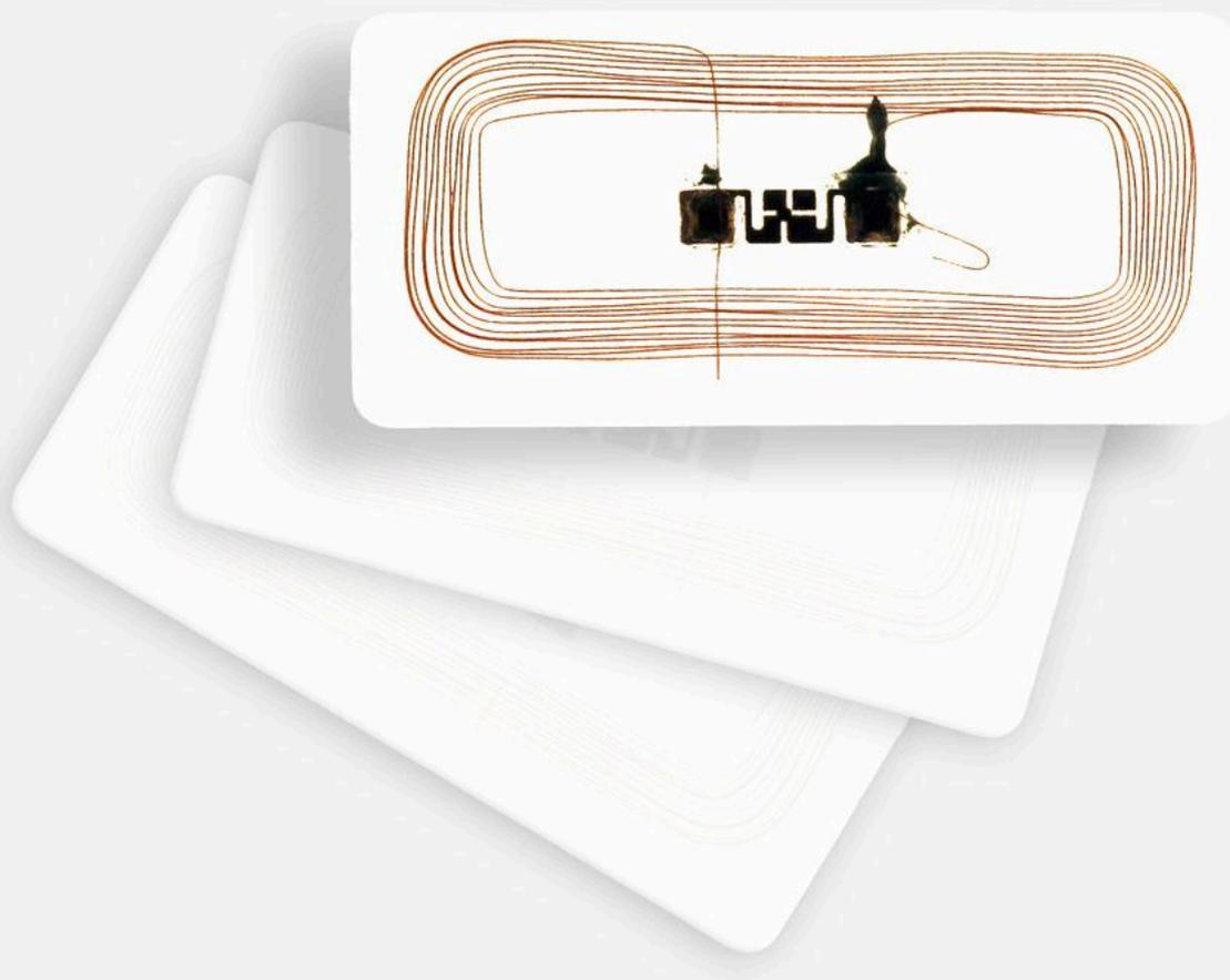
LB003 è un'etichetta RFID flessibile in carta adesiva. **Rettagonolare, misura 70 x 35 x 0,23 mm** e si applica su superfici non metalliche. È personalizzabile: la stampa e la serializzazione avvengono con tecnica offset o in inkjet, per stampe a colori e in bianco e nero, e mediante termografia, per stampe in bianco e nero. LB003 è bianca e disponibile **nella frequenza UHF, con il chip UCODE 7.**
