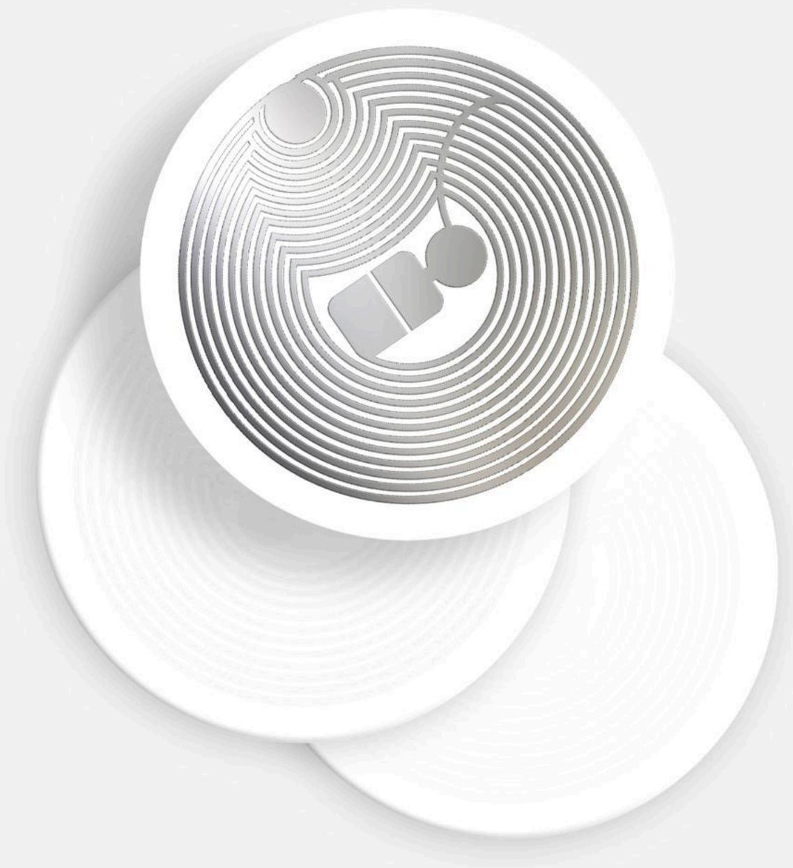
LB016 è un'etichetta RFID flessibile e adesiva, in *coated paper*. Di forma rotonda, **ha un diametro di 17 mm, mentre l'inlay o antenna in alluminio inciso ha un diametro di 15 mm**. Applicabile alle superfici non metalliche, **resiste alle alte temperature, fino a 80°C** durante le performance lavorative. È personalizzabile tramite stampa offset o inkjet, a colori e in bianco e nero, e con termografia, in bianco e
