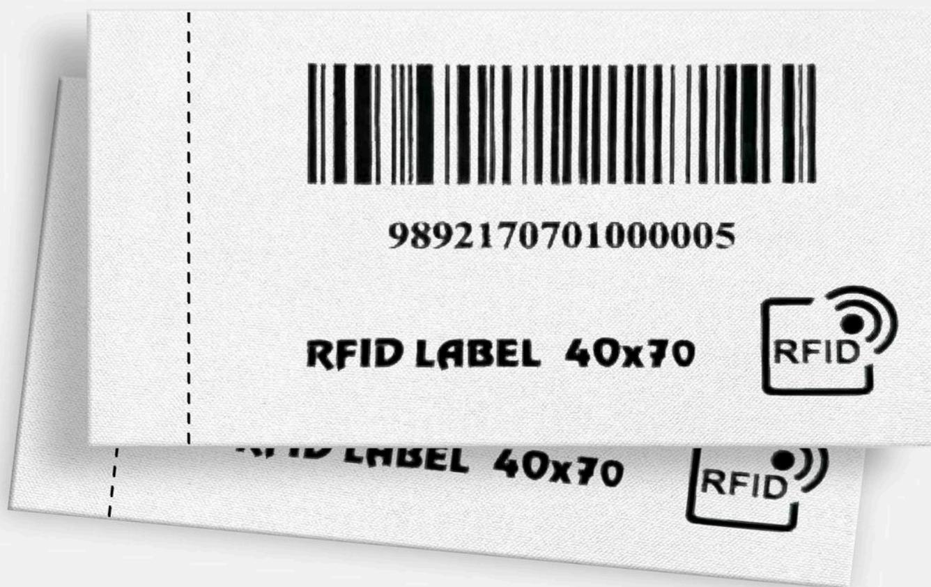
LT002 è un'etichetta RFID in **nylon taffeta, tessuto liscio, morbido e resistente all'usura**. Di forma rettangolare, **misura 40 x 70 mm**, mentre l'inlay alloggiato nel tessuto misura **30 x 50 mm**. LT002 è cucita sul capo da identificare ed è personalizzabile con stampante termografica. Bianca, è disponibile nella frequenza UHF con i chip **MONZA R6 e UCODE 7**. La distanza di lettura di questo smart label
